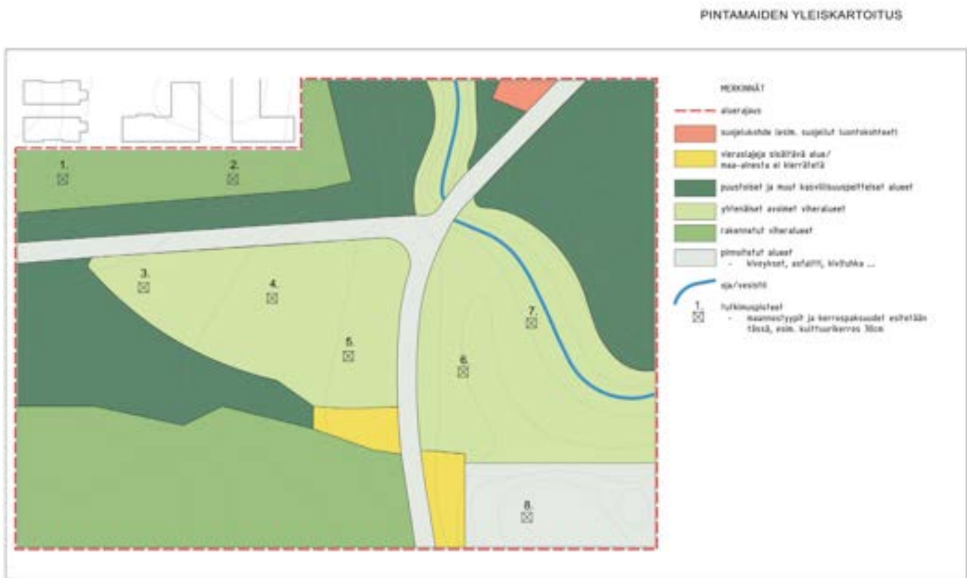
Kuva 2. Pintamaiden kartoitussuunnitelmassa alue jaetaan yhtenäiseltä vaikuttaviin alueisiin, joista pintamaan laatu tutkitaan tarkemmin. Alueen kasvillisuuspeite, pintavedet, suojelualueet ja vieraslajihavainnot kirjataan.
